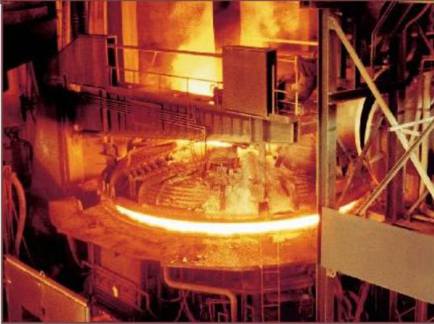
Şekil.5: Şebekede harmonik kaynağı durumundaki ark fırını
